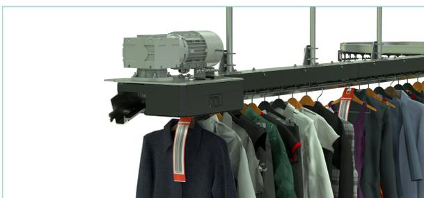
Permite la conexión entre flujos con diferentes cadencias al facilitar la acumulación de prendas antes de su paso al siguiente eslabón del proceso.
